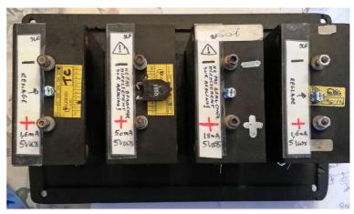
Pour les galvanomètres de 20 mA et 50 mA, il faut utiliser obligatoirement un montage amplificateur pour les piloter. Les sorties de la carte Arduino accepte 10 mA au grand maximum, et 200 mA pour le cumul de toutes les sorties.
