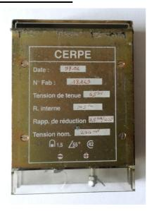
La sensibilité d'origine est de 1 mA à pleine échelle. C'est donc utilisable sous 0-5 Volts avec une résistance de 5 K Ohms en série.
