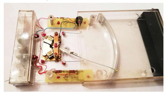
La sensibilité est maintenant d'environ 1 mA à pleine échelle. C'est donc utilisable sous 0-5 Volts avec une résistance de 5 K Ohms en série.
